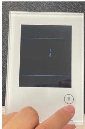
K2 を押し「0」表示を「1」へ変更し、K1 を押し次へ
