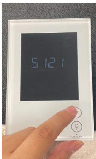
「0000」表示後、K2 で数字切り替え、K1 で決定を行い「5121」へ変更し、K1 で次の画面へ
