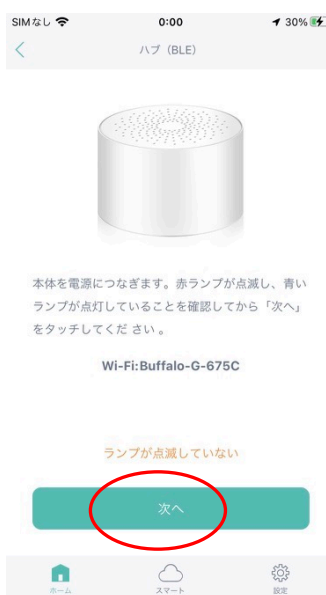
ランプが青色の点滅であること、2.4GHzのWi-Fiが表示されてあることを確認し、「次へ」をタップ
