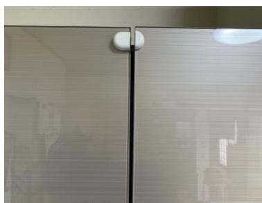
両扉に設置し、開閉を検知
