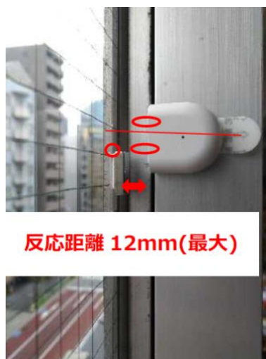
両扉に設置し、開閉を検知
