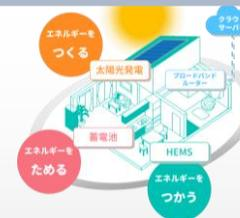
蓄電池と連携することで、家電の仕様状況に合わせた電力制御が可能になり、太陽光発電で貯めた電力のみで賄えます。
